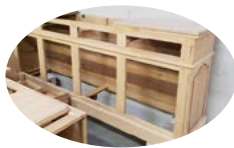
Remise au bois brut en atelier
